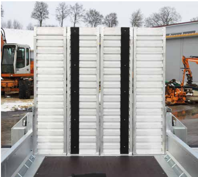
Gummiauflage mit Stahlkern auf Auffahrschienen
