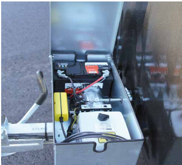
Leistungsstarke Elektrohydraulik (wassergeschützt)
